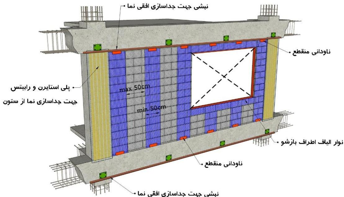
شکل ۴-۳- تسلیح دیوار در مجاورت بازشو با استفاده مش الیاف - وجه خارجی دیوار
