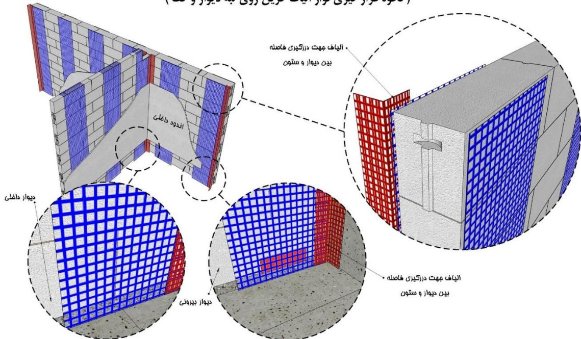
شکل ۳-۳- نحوه اجرا و تسلیح دیوارهای متقاطع با استفاده از مش الیاف
