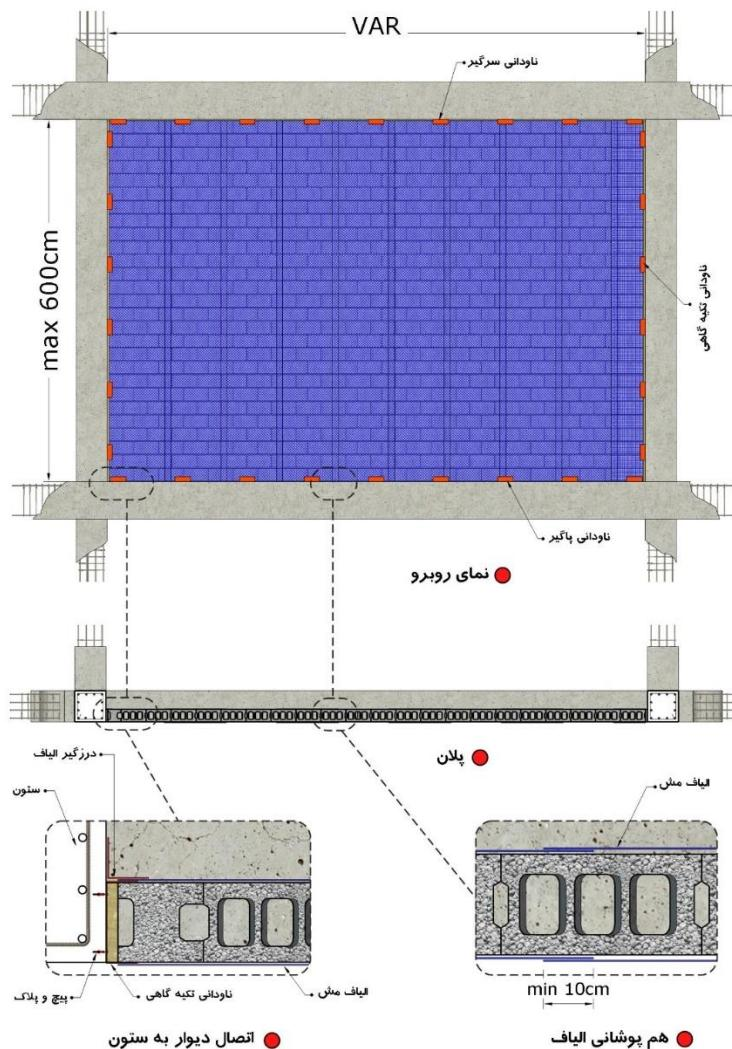
شکل ۷-۳- نمونه‌ای از تسليح دیوار تمام پوشش
