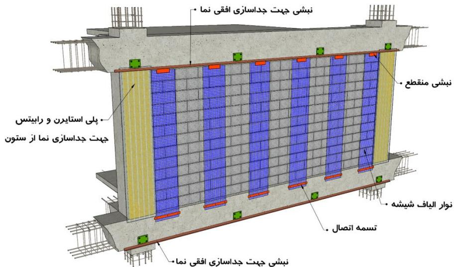
شکل ۳-۱-۳- مسلح کردن دیوارها با استفاده از نوارهای شبکه‌ای الیاف شیشه (سطح خارجی دیوار)
